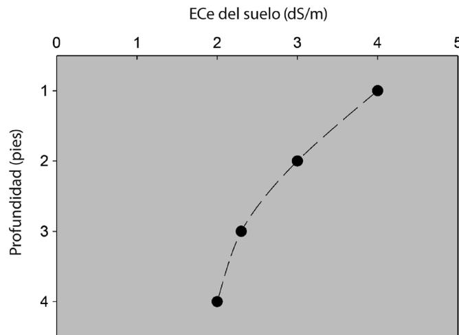
**Figura 3.** Distribución de la salinidad del suelo en la zona de raíces de un cultivo con una filtración inadecuada. Compare la salinidad del suelo promedio en la zona de las raíces con una cantidad límite de EC para la pérdida de producción del cultivo. Si la salinidad del suelo es significativamente más alta que la cantidad límite, podría necesitarse de una mayor filtración.
